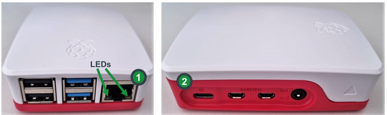
Figura 1: Porta de rede (1) e porta de energia (2) no DINO. Os LEDs indicados na figura acendem e piscam quando o cabo de rede está conectado corretamente.
